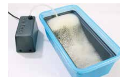
L'ÉCUME SE DÉVERSE DANS LE RÉSERVOIR
