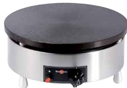
CRÊPIÈRE GAZ CONFORT Brûleur 8 branches/7 kW. Bâti inox avec 3 pieds. Chambre de combustion évitant la déperdition de chaleur. Allumage par piezo. Thermostat de régulation avec sécurité par thermocouple. Réglage automatique par dispositif thermostatique.
