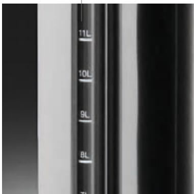
Indicateur de niveau en verre gradué
