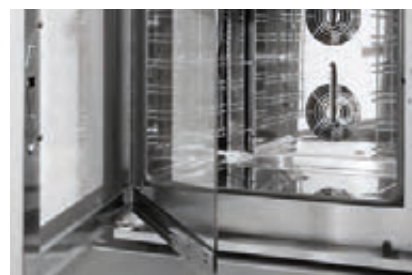
Porte en double vitrage avec ventilation par gravité, la vitre intérieur peut être enlevée pour un nettoyage facile. L'évacuation d'eau au fond de la chambre.
